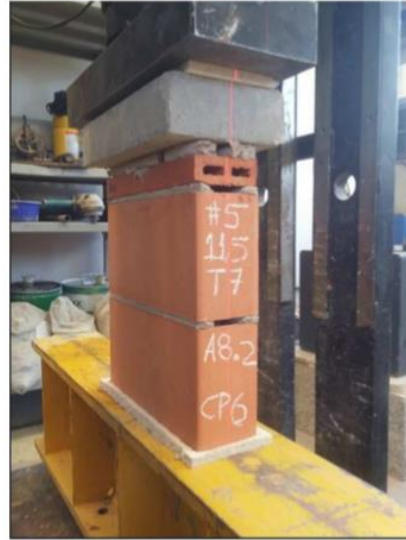
Figura 14: Montagem Prismas de 11,5x19x04 cm – (1/8)– T7 - Lateral
