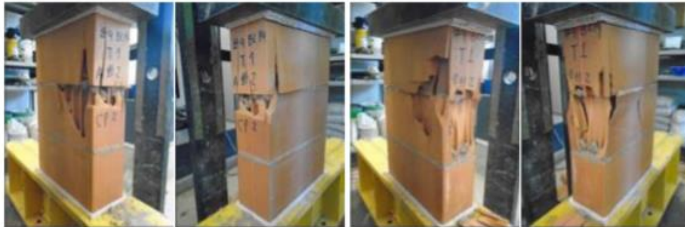
Figura 7: Forma de ruptura dos prismas de 3 blocos – T1 - Total.
