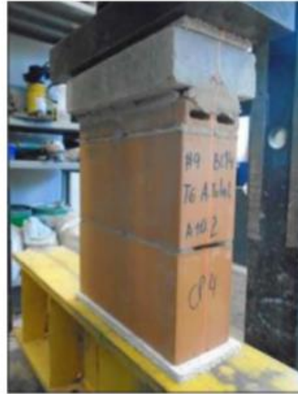
Figura 12: Montagem Prismas de 14x19x04 cm – (1/8) – T6 - Total.
