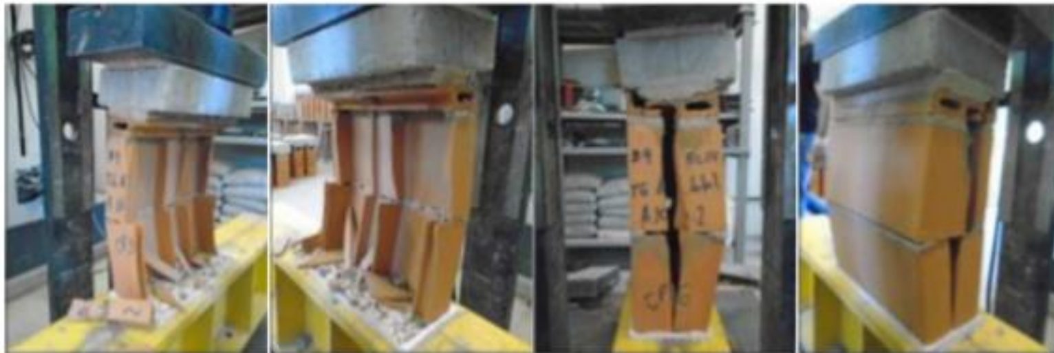
Figura 13: Forma de ruptura de prismas de 2 blocos + encunhamento de (1/8) – T6 - Total.
