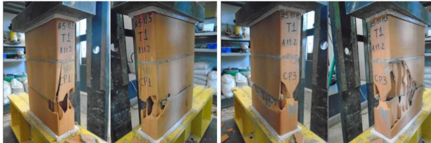
Figura 7: Forma de ruptura dos prismas de 3 blocos – T1.
